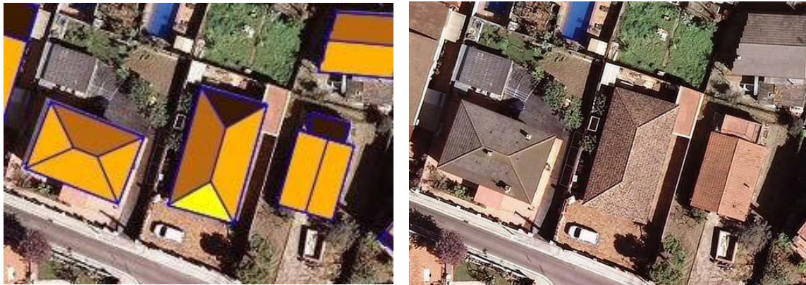
Figura 6. Esquerra: Ideïtat fotovoltaica segons element de teulada. Dreta: ortoimatge 25cm on es poden interpretar cadascun dels segments que formen la coberta dels edificis residencials.
