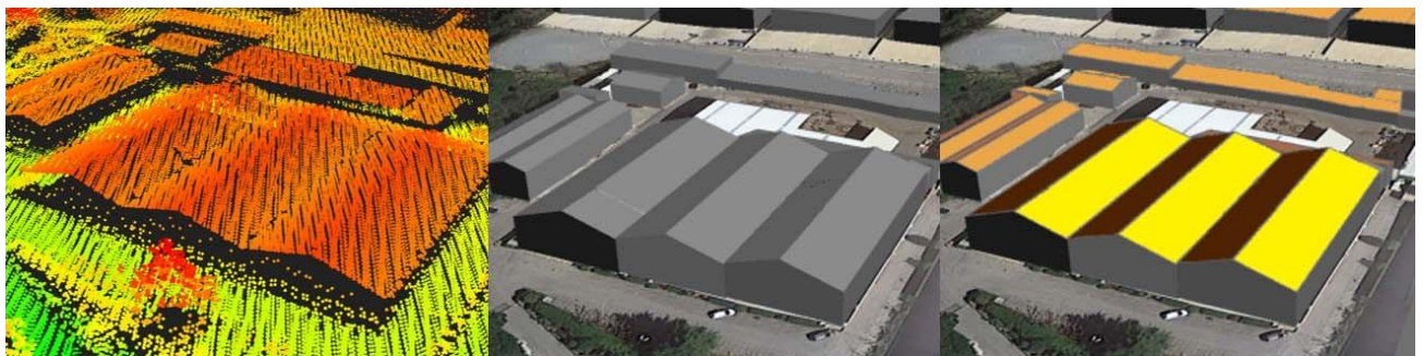
Figura 4. D'esquerra a dreta: 1) núvol de punts lidar amb tints hipsomètriques, 2) model 3D dels edificis. 3) plans de teulada classificats segons idoneïtat per a la instal·lació de panells solars.
